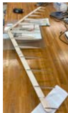
図 3.3: モジュール化した主翼
