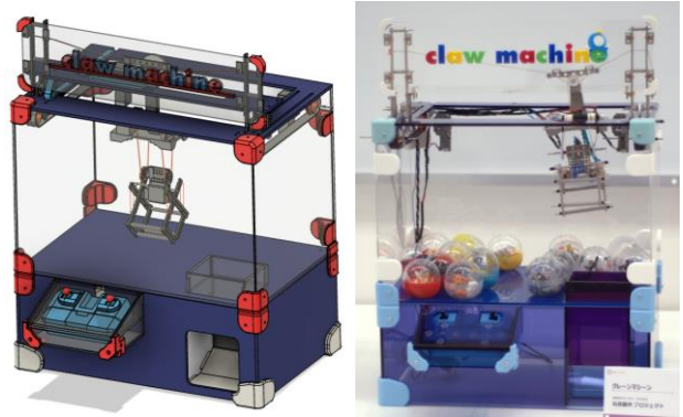
図8. 3次元モデル(左側)と完成作品(右側)
