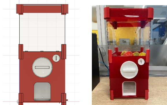
図6. 3次元モデル(左側)と完成作品(右側)
